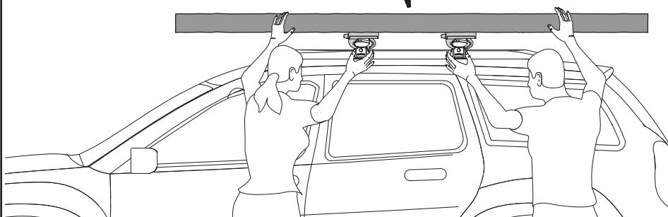
**Poser l'auvent sur le véhicule.** Avec l'aide d'un ami, placer délicatement l'auvent sur le véhicule, en enfilant les pinces sur les barres transversales. Puis serrer les pinces complètement sur les barres.
