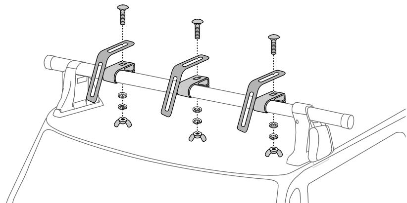
**5** À l'aide des boulons courts, fixer le carénage aux équerres en passant dans les trois trous du carénage convenant le mieux.
