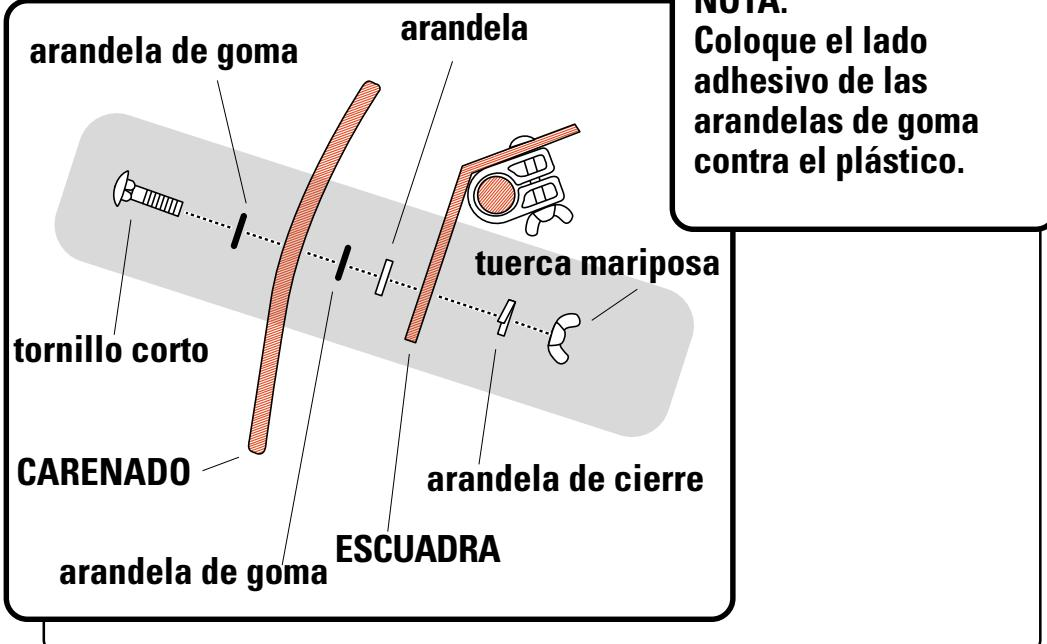
**6** Coloque el carenado para que la banda de goma (borde) se apoye sobre el marco del parabrisas. El carenado también puede apoyarse sobre el parabrisas, pero NUNCA SOBRE UNA SUPERFICIE PINTADA.
