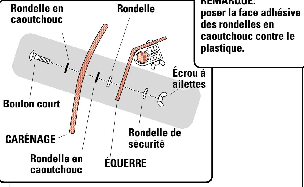
**6** Positionner le carénage de manière que la garniture en caoutchouc porte sur le cadre du pare-brise. Le carénage peut aussi porter sur le pare-brise mais JAMAIS SUR LA SURFACE PEINTE.
