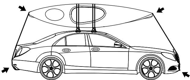
Une charge qui dépasse au-dessus du pare-brise (sauf une caisse de transport) doit obligatoirement être arrimée à l'avant et à l'arrière du véhicule, en plus du porte-bagage, sous peine de risquer de provoquer des dommages, des blessures ou même la mort.
