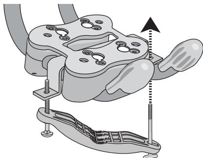
*Enfiler le boulon à tête bombée dans le trou rond et le boulon en T dans le trou allongé.*
