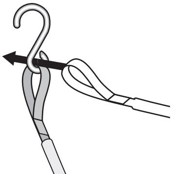
**14** Accrocher la sangle à un rebord métallique du pare-chocs, à un anneau de remorquage ou dans un trou du châssis.
