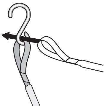
**14** Enganche la correa con el gancho de acero a una superficie metálica en el parachoques, bucle de remolque o agujero de la carrocería.
