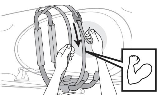
**12** Attacher la sangle avec boucle à l'embarcation.
