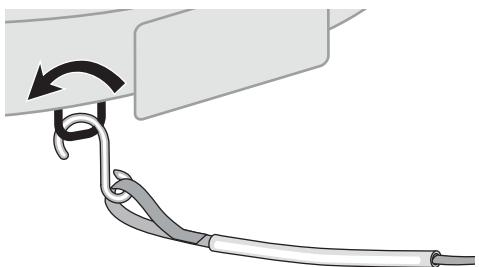
**15** Deslice el tubo de plástico para proteger el vehículo en los puntos de contacto.
