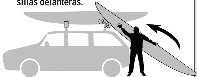
*Si es posible, uno o ambos extremos de la embarcación deberían descansar sobre las monturas.*
