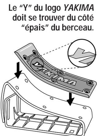
**3** POSE DES RIVETS. Enfoncer les rivets à travers la garniture, de façon qu'ils se bloquent dans le berceau.
