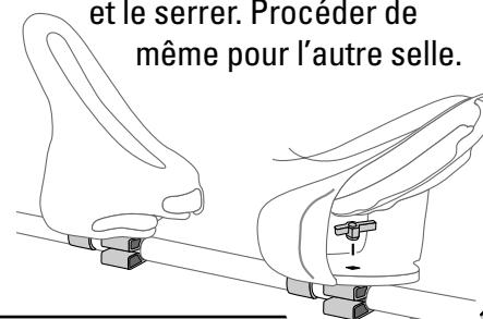
**3 Installer une autre paire de selles Mako ou une paire de rouleaux Hully Rollers sur la barre transversale ARRIÈRE. Répéter les opérations 1 à 5 pour les autres selles ou suivre les instructions de montage des rouleaux Hully Rollers.****4 Charger l'embarcation**
