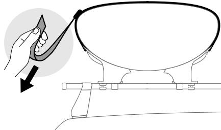
**Vérifier la solidité du montage en balançant l'embarcation. Serrer les sangles ou les boulons un peu plus s'il y a du jeu.**
