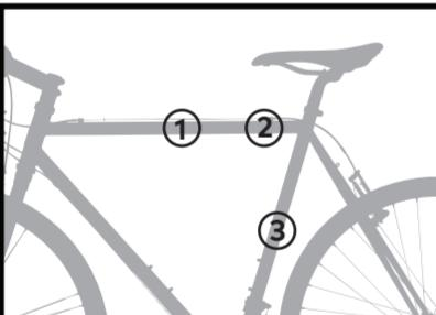
**FR** - Passez les sangles velcro dans les rainures qui s'alignent le mieux aux 3 points de fixation du dernier vélo chargé ou du support. Ensuite, fixez solidement les sangles velcro autour du vélo ou du support.
