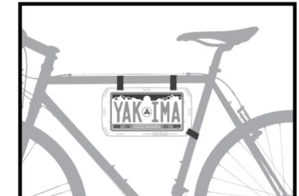
**FR** - Maintenant que le PlateMate est solidement fixé au vélo ou au support pour vélos, fixez votre plaque d'immatriculation à l'aide des écrous et des boulons en plastique fournis et serrez à la main.
