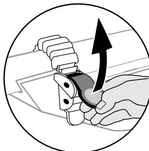
**PARA AFLOJAR,** empuje la palanca roja y tire de la correa.
