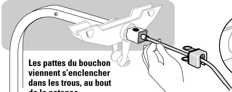
Enfoncer les pattes pour mettre le bouchon en place.
