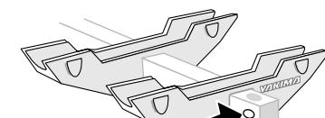
Le dernier berceau doit se trouver derrière le rivet métallique.
