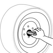
**REMARQUE:** il faudra peut-être retenir la plaque pendant le serrage des écrous de manière que la plaque n'entre pas en contact avec la roue.
