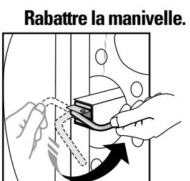
**Sur certains modèles, pour replier la manivelle complètement, il faudra peut-être l'aligner avec un trou ou un évidement de la roue.**
