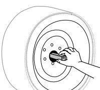
**NOTA:** Puede ser útil sostener en su sitio la TreadPlate al ajustar las tuercas para que la placa no toque la llanta.
