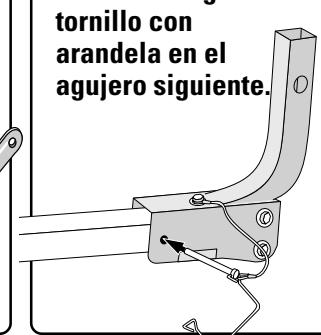
**7** Coloque el gancho de seguridad en el extremo del tornillo del enganche.
