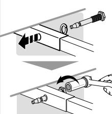
Employer une clé à douille de 23 mm (7/8 po) ou de 24 mm (15/16 po) et SERRER.
