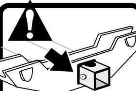
**Le dernier berceau doit être derrière le rivet métallique. Serrer le boulon!**
