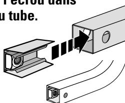
Le trou de l'attelage doit être aligné avec celui du tube.
