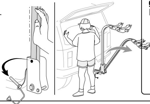
**Ne pas oublier de remettre la goupille en place ET de raccrocher l'étrier de sécurité.**
