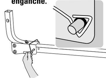
**8****INSTALE LA TUERCA DEL ENGANCHE Y COLOQUE LA BASE EN EL ENGANCHE.**
