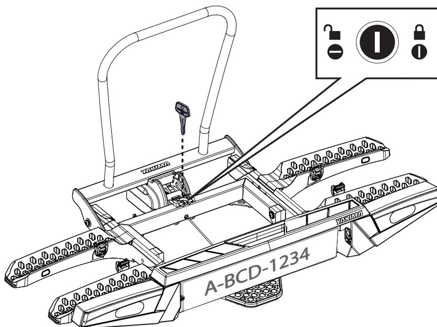
**DE** Verriegeln Sie den Träger an der Anhängerkupplung und ziehen Sie den Schlüssel ab.
