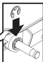
Installer le support de roue. Insérer l'axe tel qu'il illustré et le bloquer à l'aide de l'anneau élastique.
