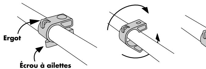
boulon et l'écrou à ailettes sans les serrer. Enfiler le profilé sur la tête du boulon et l'ergot. Serrer l'écrou à ailettes.
