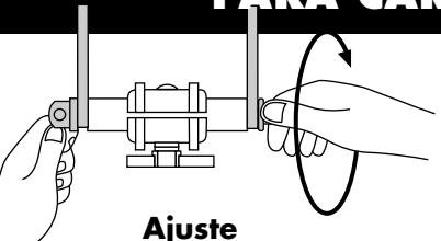
Cierre la broqueta levantando la palanca 180°. A mitad de camino comenzará a sentir resistencia. Tenga cuidado de no ajustar demasiado la palanca, pero cerciórese de que la horquilla queda firme sobre la broqueta. Para cerrar la broqueta se debe ejercer presión firme, suficiente para dejar una impresión en la palma de la mano. Si la broqueta está demasiado floja o apretada, abra la broqueta y ajústela, girando la tuerca, no la palanca.
