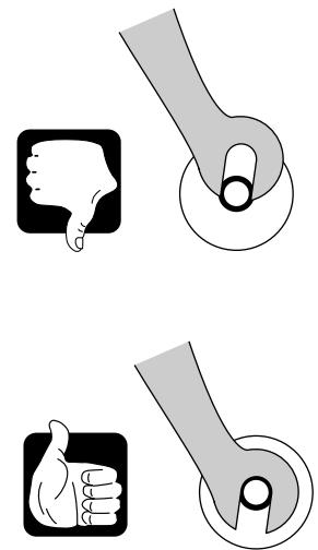
S'assurer que les pattes de la fourche sont engagées à fond sur les bouts de l'axe du bloc de fixation. (Si la fourche est difficile à retirer de l'axe, ouvrir le levier et desserrer un peu l'écrou de l'axe.)
