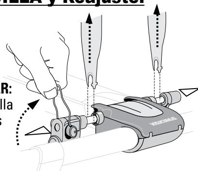
**PARA REAJUSTAR:** Levante la anilla; coloque los tirantes; CIERRE. Puede no ser necesario ajustar la perilla si se trata de la misma bicicleta.
