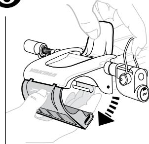
**NOTE:** la boucle doit absolument être relevée à fond pour que l'on puisse ouvrir ou fermer la mâchoire.
