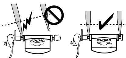
*Ponga un cuidado especial al instalar o retirar las bicicletas que tienen HORQUILLAS DE FIBRA DE CARBONO. Los extremos de la horquilla se pueden agrietar o doblar si la bicicleta no se carga verticalmente.*
