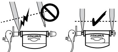
*Faire particulièrement attention quand on charge ou décharge des vélos À FOURCHE EN FIBRE DE CARBONE. Les pattes de la fourche pourraient casser ou plier si le vélo n'est pas chargé verticalement.*
