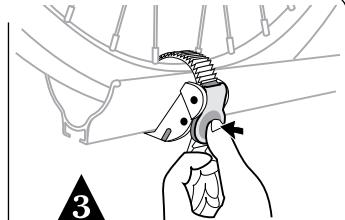
Algunas ruedas pueden ser muy finas para ajustar bien. Deslice la correa en el riel hasta que se apoye bien en la llanta. Ajuste.
