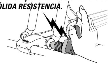
**¡VERIFIQUE EL MONTAJE!** Si una vez montada, la horquilla aún se puede mover, abra la manija y apriete la perilla de ajuste un poco más.
