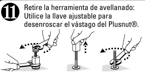
Retire la herramienta de avellanado: Utilice la llave ajustable para desenroscar el vástago del Plusnut®.
