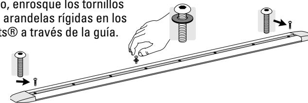
No utilice arandelas en los tornillos de cada extremo de las guías.
