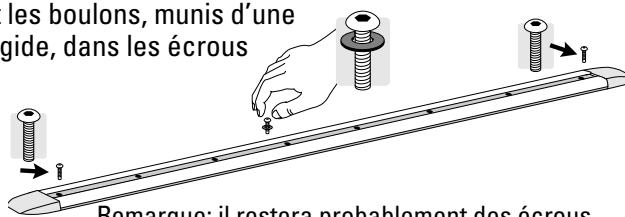
Remarque: il restera probablement des écrous Plusnut®, des boulons et des rondelles puisque tous les trous de la glissière ne sont pas employés.
