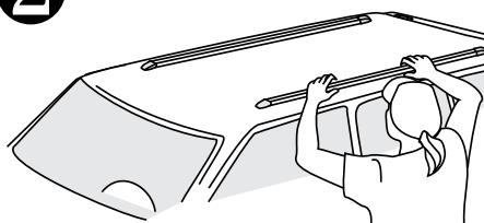
Coloque las dos guías sobre el techo. Determine cuidadosamente las posiciones de ambas guías, asegurándose de que queden alineadas entre sí y ubicadas simétricamente en relación al vehículo. Utilice una cinta adhesiva para mantener las guías en su sitio.
