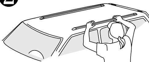
Déposer les deux glissières sur le toit. Choisir leur emplacement avec soin, en veillant à ce qu'elles soient alignées l'une par rapport à l'autre et symétriques par rapport au véhicule. Les immobiliser avec précision avec du ruban-cache.
