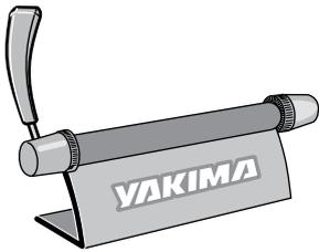
**Le bloc de retenue de fourche BlockHead verrouillable se fixe solidement aux surfaces plates. Visserie recommandée pour l'installation: boulons ou vis de 6 mm (1/4 po), rondelles de protection, écrous autofreinés.**
