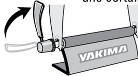
Serrer ou desserrer l'écrou au besoin de manière que le levier se ferme avec une certaine résistance.
