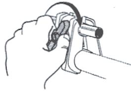
**14** Remove skewer nut. / *Enlever l'écrou de l'axe à serrage rapide.*
