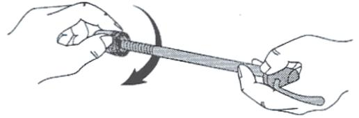
**15** Insert skewer into fork block. / *Enfiler l'axe dans le bloc de fourche.*
