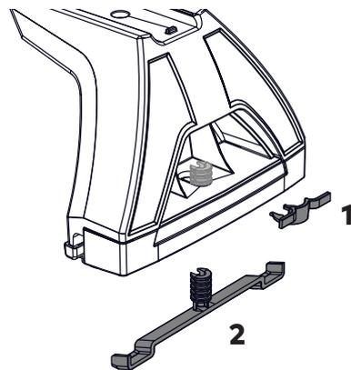
**3****LOOSEN GUTTER MOUNT PLATE**
