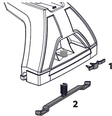
**3 LOOSEN GUTTER MOUNT PLATE**
