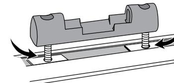
**REMARQUE:** si les vis semblent trop courtes pour s'engager dans les plaquettes, sortir les vis, enlever l'entretoise en plastique et ne garder que la rondelle.
