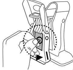
**2 INSTALE LOS SOPORTES EN LOS TRAVESAÑOS SOBRE UNA SUPERFICIE PLANA:**
