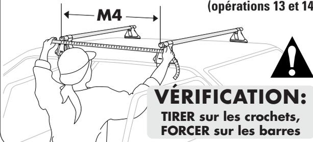
VÉRIFICATION: TIRER sur les crochets, FORCER sur les barres
