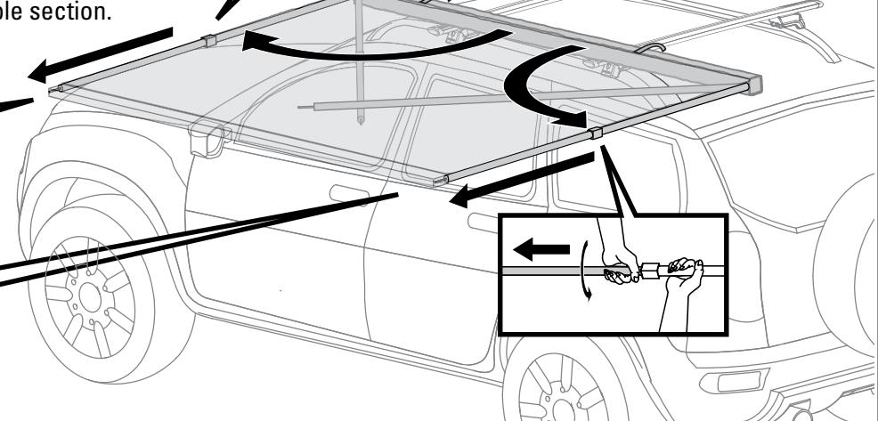
Déplier les tubes latéraux. Tourner le tube extérieur d'un quart de tour pour le déverrouiller et en régler la longueur. Enfiler la pointe dans les trous, puis allonger le tube et le tourner dans l'autre sens pour en bloquer la longueur. **REMARQUE :** Ne pas faire tourner les blocs cubiques, ne faire tourner que la section de poteau.
