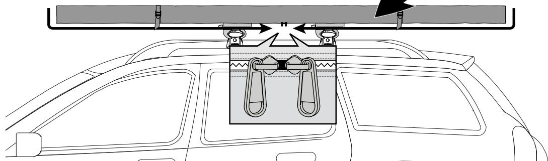
Enfoncer l'auvent roulé fermement contre les tubes latéraux, attacher les sangles velcro autour de l'auvent et remettre la housse en place. Refermer la glissière en faisant attention de ne pas y coincer le tissu.
