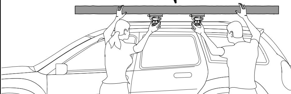
**Poser l'auvent sur le véhicule.** Avec l'aide d'un ami, placer délicatement l'auvent sur le véhicule, en enfiler les pinces sur les barres transversales. Puis serrer les pinces complètement sur les barres.
