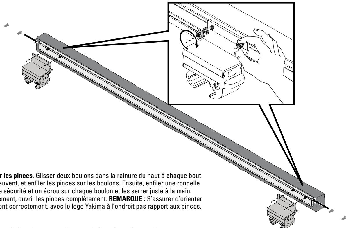
**Poser les pinces.** Glisser deux boulons dans la rainure du haut à chaque bout de l'auvent, et enfiler les pinces sur les boulons. Ensuite, enfiler une rondelle de sécurité et un écrou sur chaque boulon et les serrer juste à la main. Finalement, ouvrir les pinces complètement. **REMARQUE :** S'assurer d'orienter l'auvent correctement, avec le logo Yakima à l'endroit pas rapport aux pinces.
