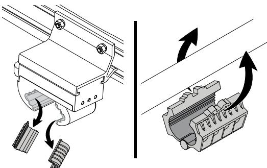
Si tiene barras redondas de Yakima, debe utilizar los adaptadores provistos para ese tipo de barras. Primero, retire las almohadillas de las abrazaderas y luego coloque los adaptadores alrededor de las barras con la bisagra orientada hacia abajo. Por último, introduzca las abrazaderas en los adaptadores.
