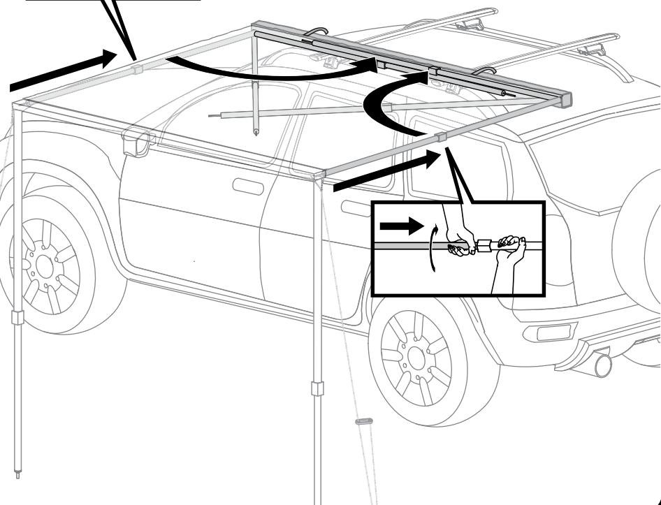
**Détacher les sangles velcro des tubes latéraux. Replier et ranger les tubes latéraux.** Tourner les tubes latéraux d'un quart de tour pour les déverrouiller et les raccourcir, puis les replier dans leur logement. Les bloquer en les enfonçant en place.
