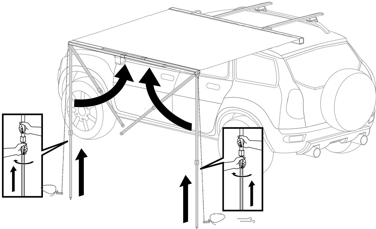
**Replier et ranger les poteaux avant.** Relâcher les tendeurs et enlever les piquets. Tourner les poteaux pour les déverrouiller et les raccourcir, puis les replier dans leur logement. Les bloquer en les enfonçant en place.
