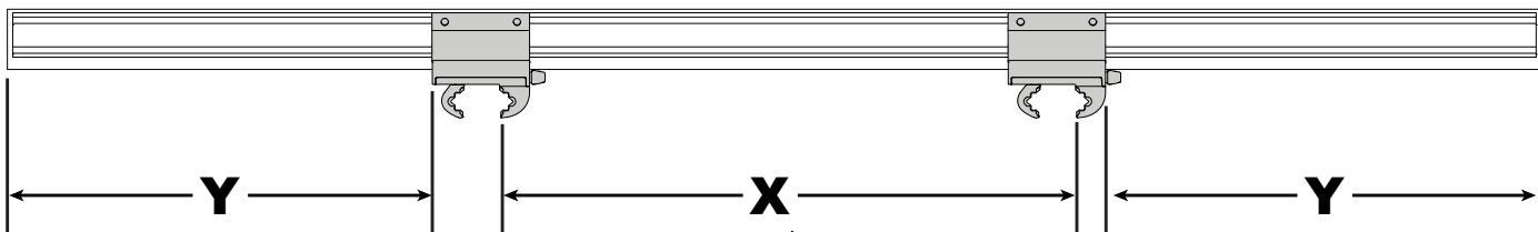
**Positionner les pinces.** Mesurer la distance entre les barres transversales, puis régler la distance entre les pinces. Pour les véhicules munis d'un hayon, on peut avoir une distance maximale à 120 cm (47 po) entre le centre de la mâchoire vissée la plus proche et le bout de l'auvent.
