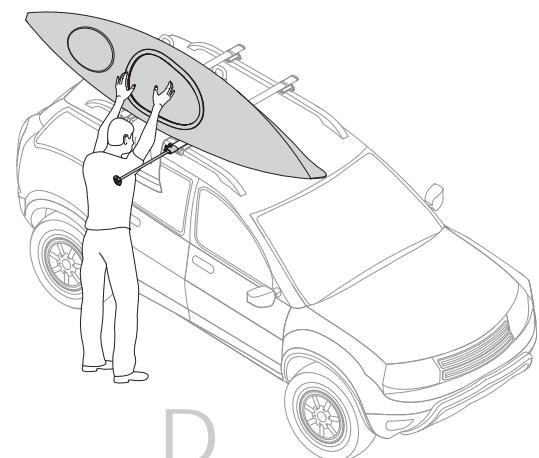
Appuyer l'embarcation contre le bras EVO. Prendre tout le temps nécessaire pour installer l'embarcation sur le véhicule. **Prendre soin de ne pas laisser l'embarcation glisser et tomber au sol.**
