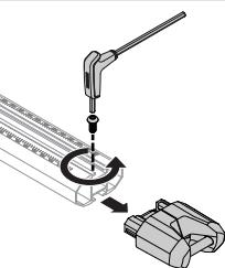
À l'aide de la clé hexagonale de 4 mm, retirer un capuchon d'extrême des barres HD.
