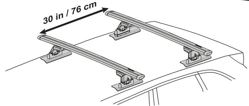
**Nota:** la separación entre travesaños para este vehículo se fija en 30 pulgadas (76 cm).
