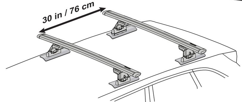
Remarque: pour ce véhicule, la distance entre les barres transversales est fixée à 76 cm (30 po).
