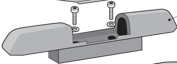
SEPARADOR (ÚNICAMENTE PARA EL MODELO HONDA ELEMENT SC)
