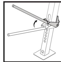
**Facultatif :** employer la barre pour avoir plus de force. L'enfiler complètement à travers les deux trous (à l'avant et à l'arrière) et allonger la béquille progressivement, en l'insérant dans un trou puis dans le suivant.
