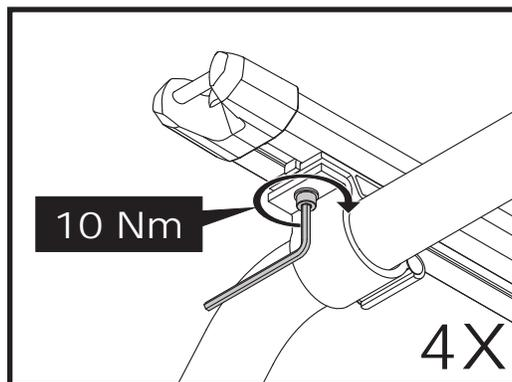
Avant d'installer la tente, s'assurer que la barre transversale avant est bien dans la position la plus à l'avant. Poser la barre transversale arrière à 81 cm (32 po) de la barre avant. Serrer les barres à 10 Nm.
