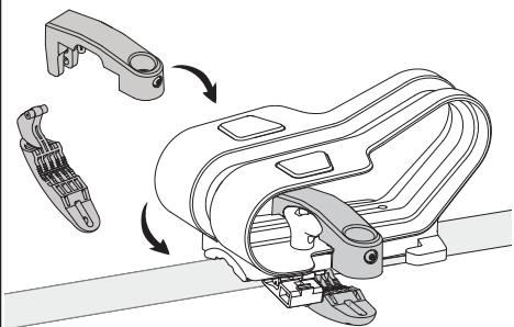
**Remettre les mâchoires en place.** Placer les mâchoires supérieure et inférieure autour de la barre. S'assurer que la mâchoire supérieure s'enclenche bien dans la selle et enfiler la mâchoire inférieure à la position centrale dans la mâchoire supérieure.
