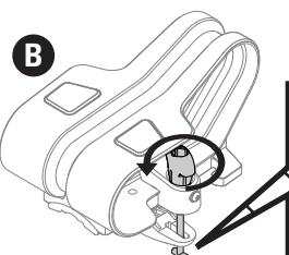
Préparer les selles pour y installer les adaptateurs. Retirer le bouton, le boulon en T, la mâchoire supérieure et la mâchoire inférieure.
