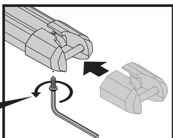
Remettre en place les capuchons d'extrême et serrer la vis à 3,5 Nm.
