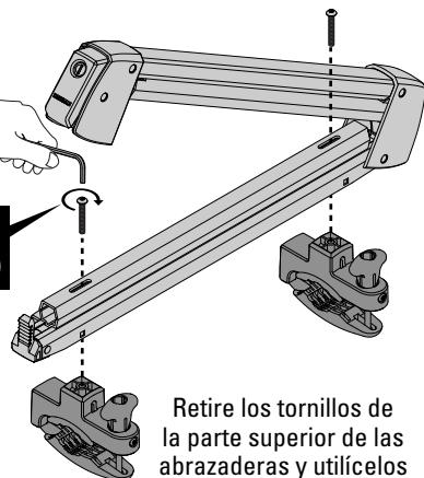
Retire los tornillos de la parte superior de las abrazaderas y utilícelos para instalarlas.
