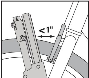
Rote el brazo pivotante hacia arriba hasta que el gancho quede sobre el neumático a 1" o menos de los frenos o de la horquilla de la bicicleta.
