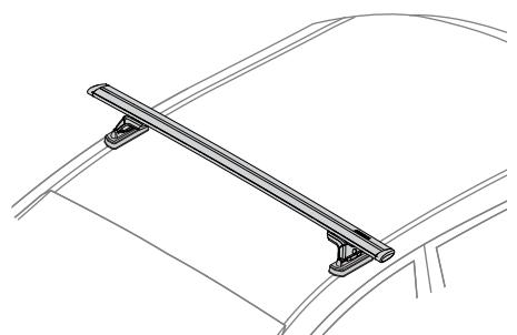
D. Abra una tapa de una torre SkyLine o Control Tower y manténgala levantada mientras la torre opuesta sigue enganchada.
