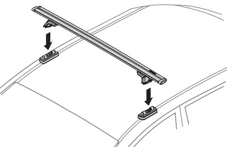
B. Alinee la posición de las Landing Pads para permitir que las torres SkyLine o Control Towers queden correctamente posicionadas.
