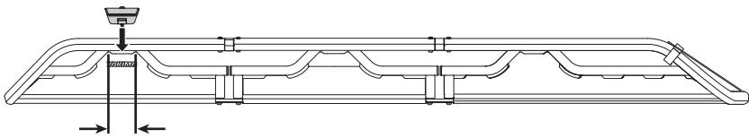
**IMPORTANT !** Si l'on compte se servir des barres pour accessoires pour poser un porte-vélo ou un porte-embarcation, la barre pour accessoire arrière doit être installée à cet endroit !
