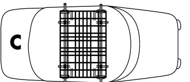
**S'assurer que les boulons passent à travers les arceaux qui sont AU FOND du panier.**
