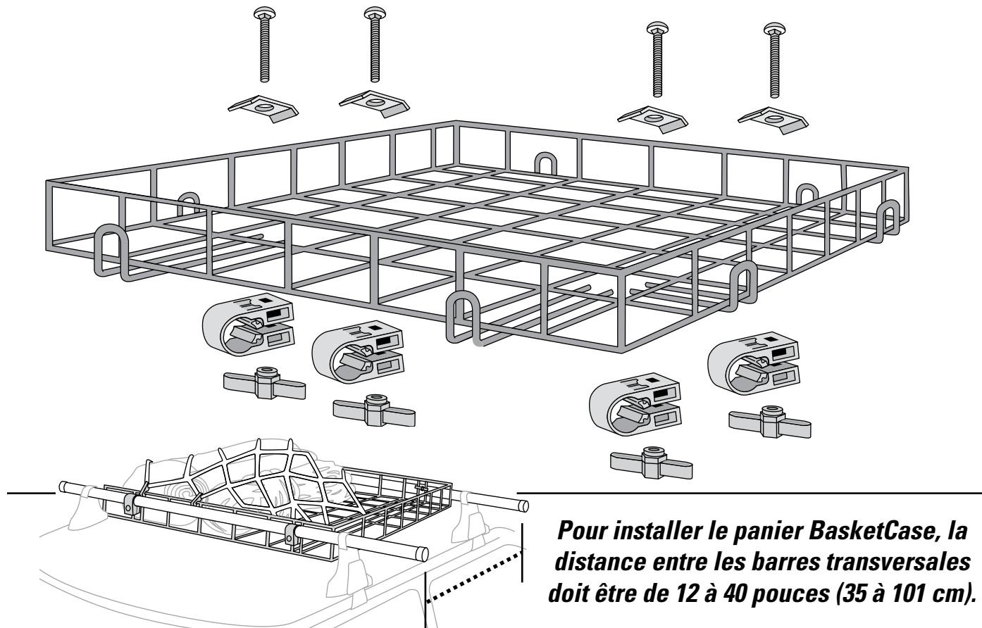
**Pour installer le panier BasketCase, la distance entre les barres transversales doit être de 12 à 40 pouces (35 à 101 cm).**
