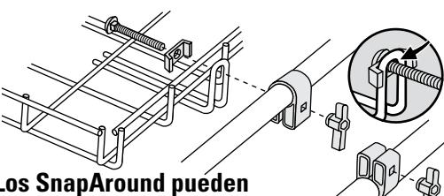
Los SnapAround pueden orientarse hacia arriba o hacia abajo, pero el tornillo debe quedar SIEMPRE en la parte superior de la anilla.
