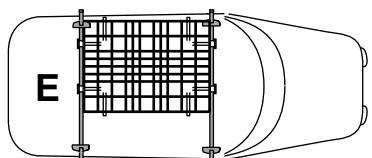
**S'assurer que les boulons passent à travers les arceaux qui sont SUR LES CÔTÉS du panier.**
