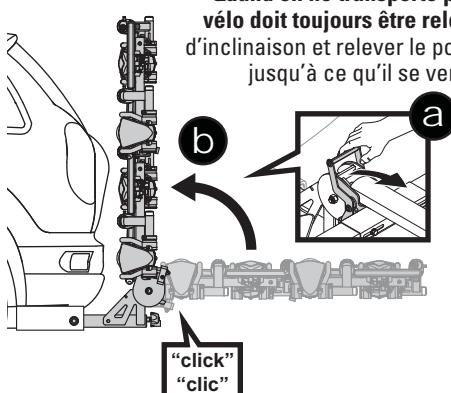
**Cuando no transporte bicicletas, mantenga siempre el HoldUp Evo plegado hacia arriba.** Tire de la palanca de reclinado y pliegue el HoldUp Evo completamente hacia arriba hasta que quede trabado en su posición.
