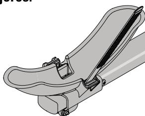
**Asegure el tubo de soporte usando la llave provista. Sujete y apriete los dos juegos de tornillos, arandelas y arandelas de cierre.**
