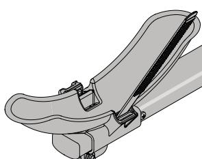
Fixer le support à l'aide de la clé fournie en serrant bien les boulons et les écrous.
