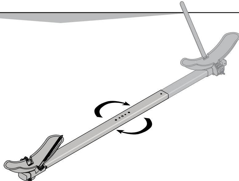
**Coloque el tubo de soporte girado dentro de la placa de fijación. Alinee los agujeros.**
