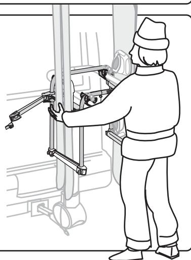
**PARA DESCARGAR,** destrabe y abra las palancas de leva.
