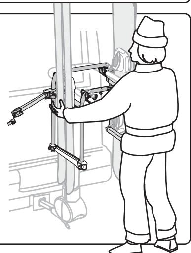
**POUR DÉCHARGER,** déverrouiller et ouvrir les leviers. Il est inutile de modifier le réglage des molettes pour décharger.
