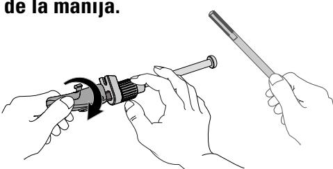
Sostenga la perilla de ajuste. Gire la palanca en sentido horario para sacar el eje.
