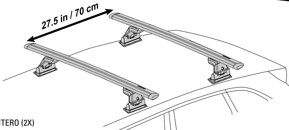
*Nota: La separación de la barra transversal de este vehículo se fija en 27,5 pulgadas/70 centímetros.*
