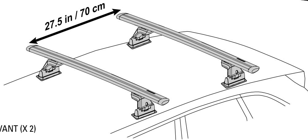
*Remarque: pour ce véhicule, la distance entre les barres transversales est fixée à 70 cm (27,5 po).*
