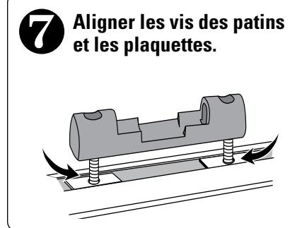
**REMARQUE:** si les vis semblent trop courtes pour s'engager dans les plaquettes, sortir les vis, enlever l'entretoise en plastique et ne garder que la rondelle.
