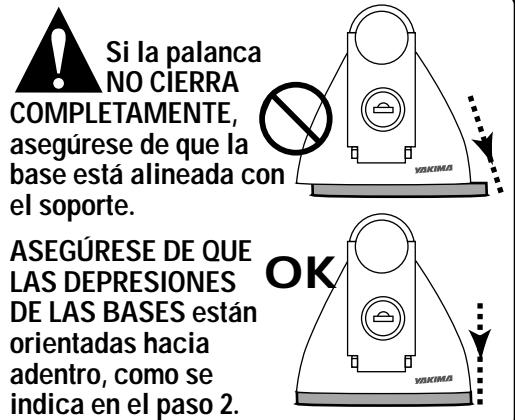
NOTA: El cierre de las palancas ENGANCHA los soportes a las bases.
